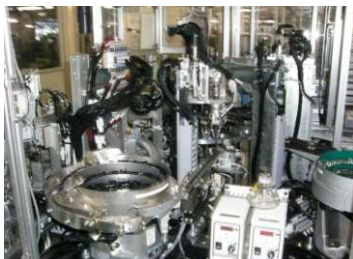
油温センサー自動組立工程
