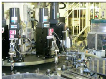
オイルプレッシャースイッチ 自動組立工程
